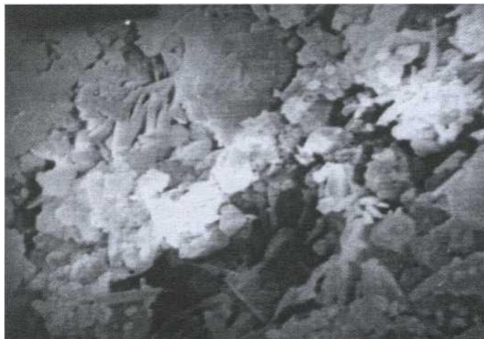
Рис. 3. Структура образца, содержащего 80 % известняковых попутных продуктов, 10% силикатной глыбы и 10 % пиритных огарков. Увеличение 5000х
