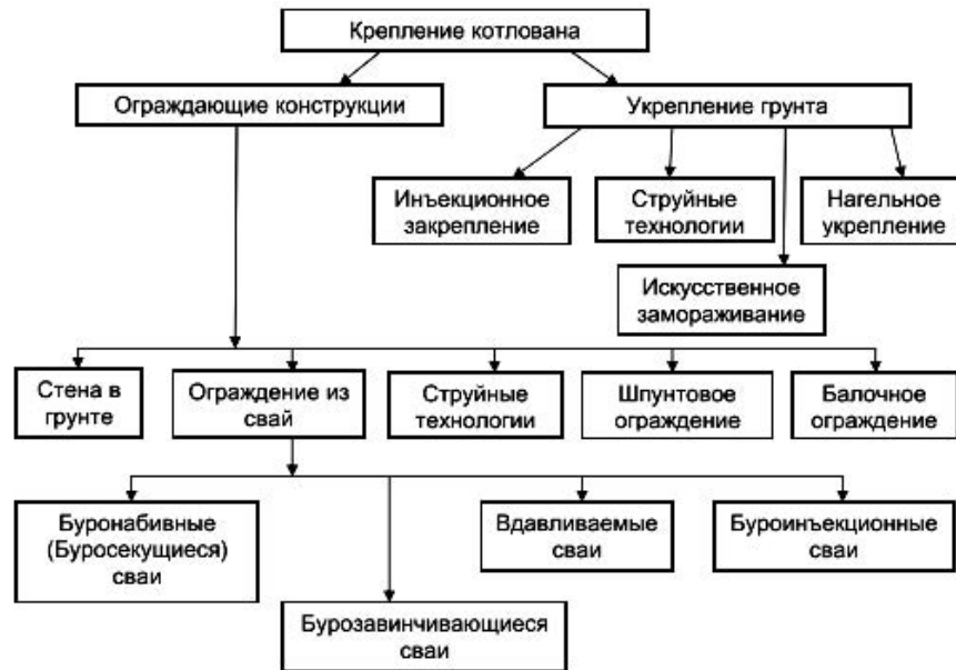
Рис. 2. Классификация современных методов крепления котлованов
