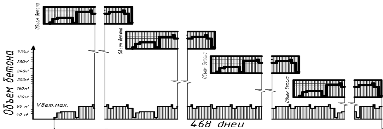
Рис.1. Графики последовательного возведения комплекса каркасов наземной части 4 жилых домов и потребности рабочих кадров, а также бетонной смеси
