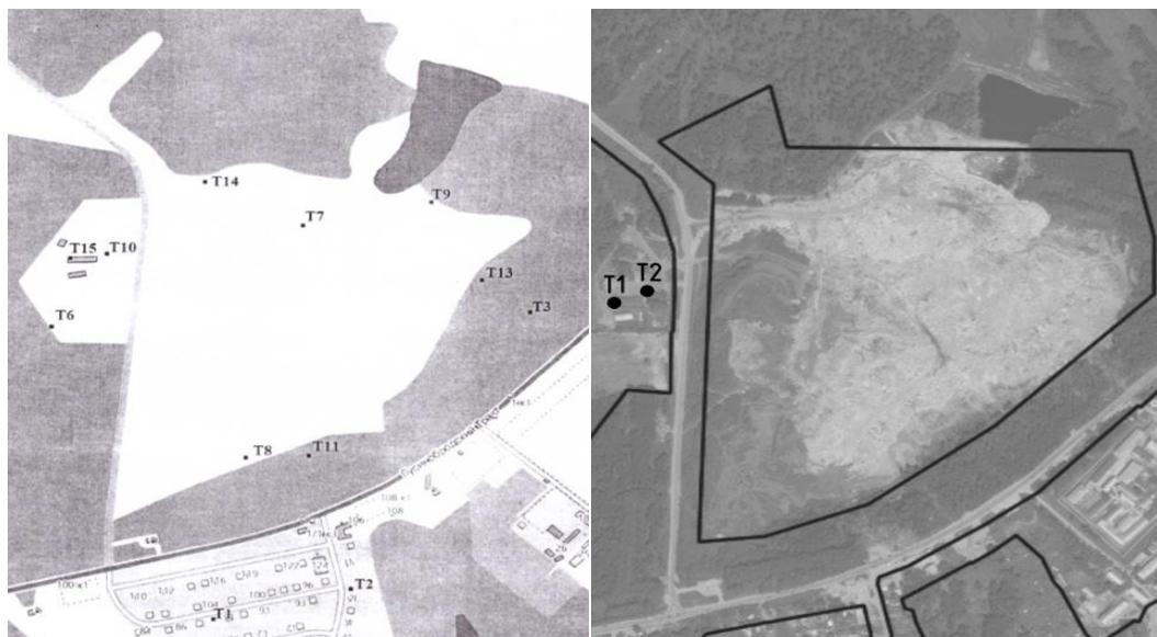
Рис. 2. Карта расположения скважин: T1...T15 – скважины; T1 (T15) – скважина у административного здания; T2 (T10) – скважина на территории полигона
