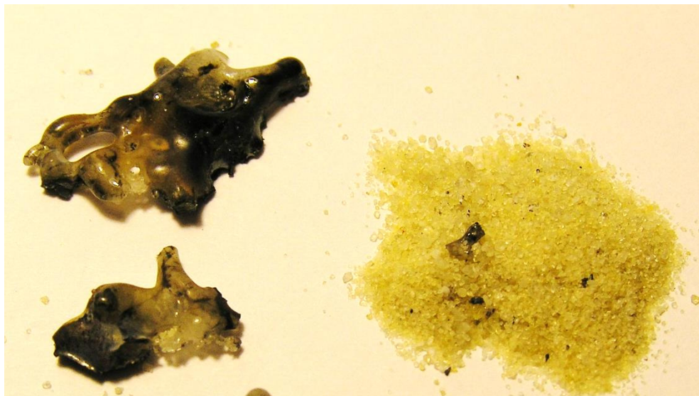
Рис. 9. Остеклованная масса, полученная из песка ( \text{SiO}_2 ) в результате кратковременного воздействия струи высокотемпературной плазмы [22]
