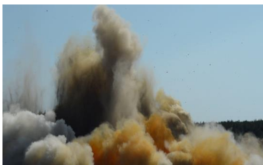
Рис. 1. Массовый взрыв для рыхления горных пород на карьере Ульяновского месторождения известняков.
