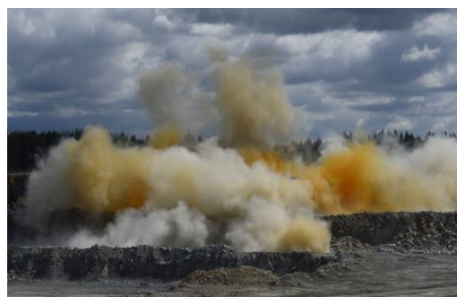
Рис. 1. Массовый взрыв для рыхления горных пород на карьере Ульяновского месторождения известняков.
