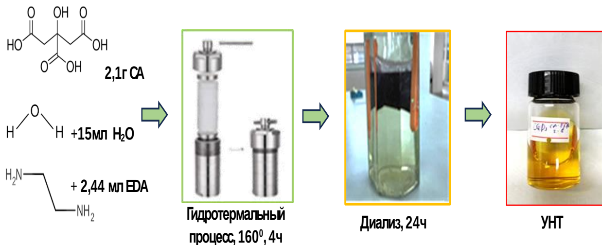
Рис. 1. Принципиальная схема синтеза и очистки УКТ
