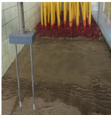
Рис. 6. Датчик-волнограф В1 в рабочем положении
