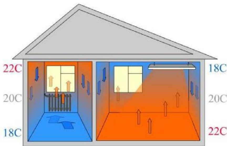
Рис. 1. Различия между традиционным и инфракрасным отоплением [2]
