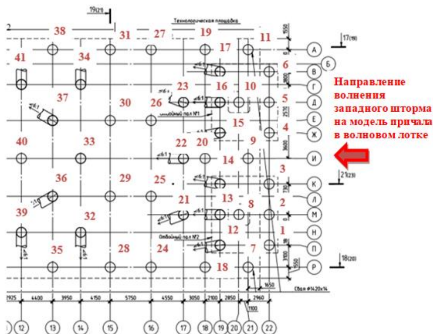
Рис. 7. Нумерация свай сооружения причала
