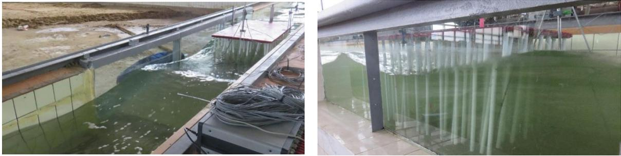
Рис. 8. Прохождение волны под ростверком сооружения причала
