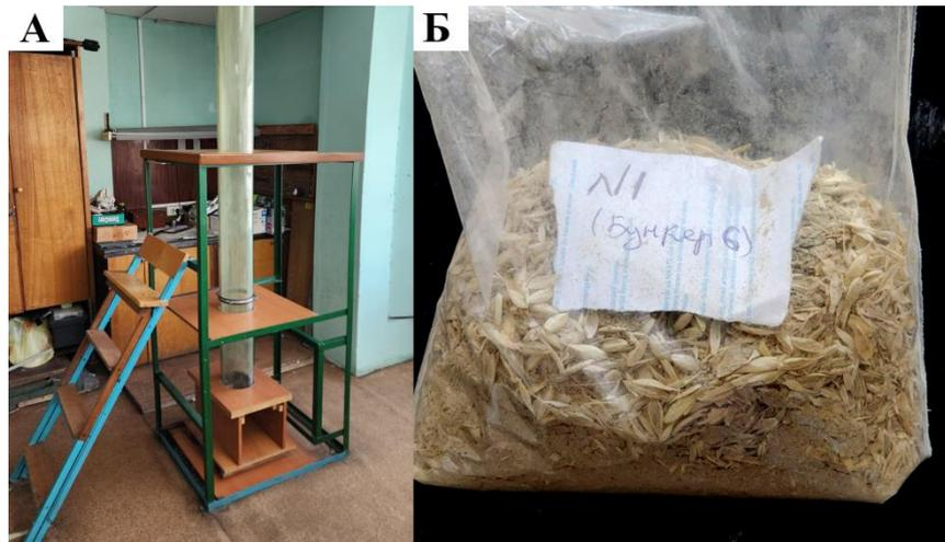
Рис.1. а) Экспериментальная установка для определения скорости оседания пыли. б) Исследуемый образец пыли, бункер №6, оборудованный автоматической системой аспирации приема. Проба взята в Городищенском комбинате хлебопродуктов, рп. Новый Рогачик, Волгоградская область.
