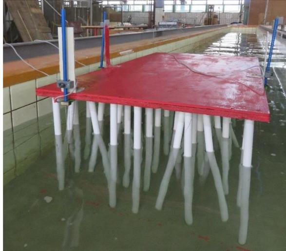
Рис. 4. Подготовленная к экспериментам модель причала
