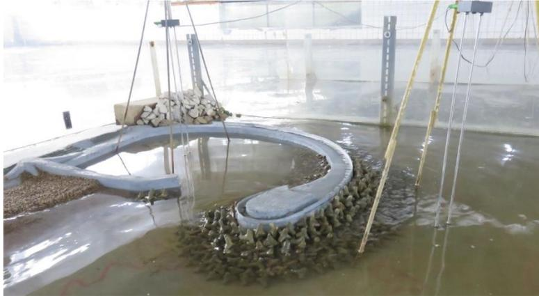
Рис. 14. Экспериментальные исследования сейшевых колебаний (резонанса)
