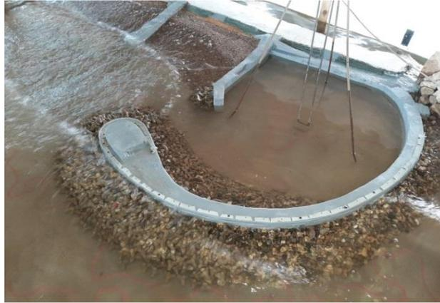
Рис. 11. Экспериментальные исследования по изучению устойчивости защитной наброски из тетрапов
