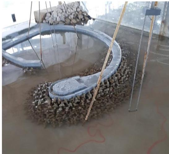
Рис. 10. Усиление защитной наброски оградительного мола тетраподами
