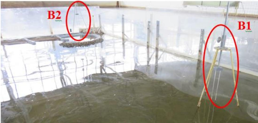
Рис. 4. Нумерация волнографов и их расположение на акватории модели
