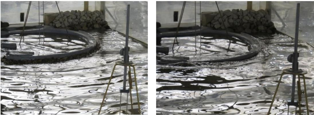
Рис. 9. Экспериментальные исследования по исследованию защищенности огражденной акватории марины
