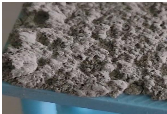
Рис.3. Упакованная мелкодисперсная пыль, сдуваемая воздушным потоком в лабораторной установке.
