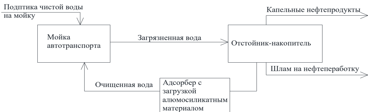
Рис. 3. Технологическая блок-схема очистки сточной воды после внедрения технологии.
