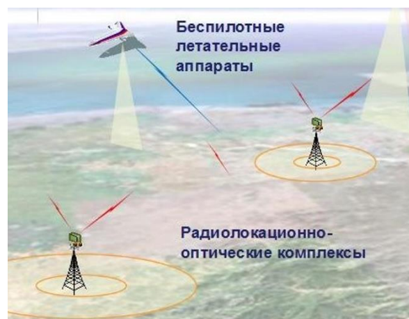
Рис. 5. Радиотехническая система навигации БПЛА [6]
