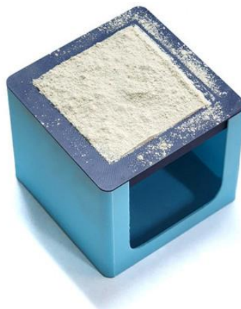
Рис.3. Пластина на подставке с навеской гипсовой пыли.
